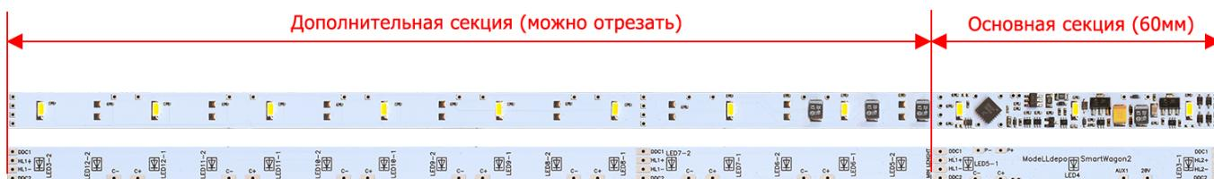
Декодер необходимо подключить к токосъему, для этого потребуется 2 провода, можно использовать как собственный токосъем вагона, так и токосъем локомотива, в последнем случае придется тянуть провода в локомотив через сцепку.
